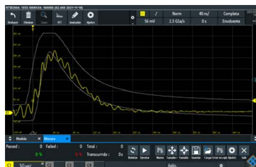
Fig. 6: Pulso de tensión a la salida del módulo electrónico a larga distancia del objeto designado.
