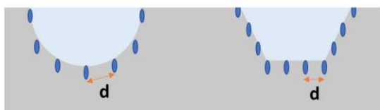
Fig. 2: Esquema de la distribución de los tracks que forman la guía de onda. Los tracks se encuentran equiespaciados, siendo "d" la distancia entre los centros de los mismos.
