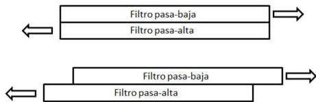
Fig. 7: Esquema del filtro lineal variable y del movimiento relativo de los dos filtros que lo forman.
