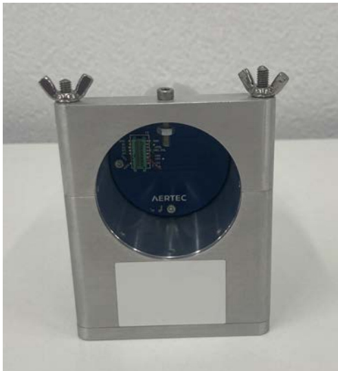
Fig. 3: Vista trasera del sistema SAL-seeker.
