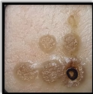
Fig. 5: Ejemplo de una muestra después de realizar el proceso ablativo en los nueve puntos señalados anteriormente.
