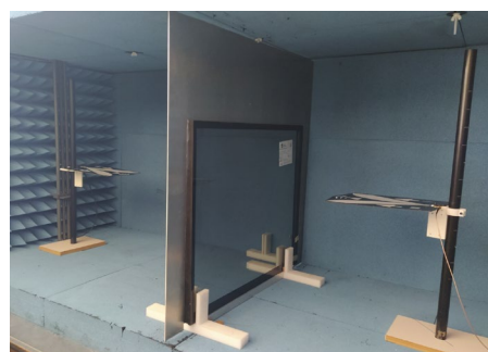
Fig. 4: Montaje experimental en cámara anecoica
