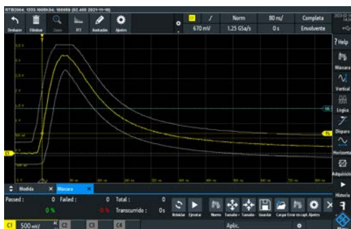
Fig. 5: Pulso de tensión a la salida del módulo electrónico a corta distancia del objeto designado.
