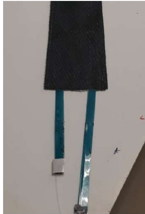
Fig. 6: Detalle de una pieza terminada, con la fibra óptica embebida en el sustrato y entrelazada en la estera de fibra de carbono. Las terminaciones están protegidas por cinta azul para evitar daños por manipulación
